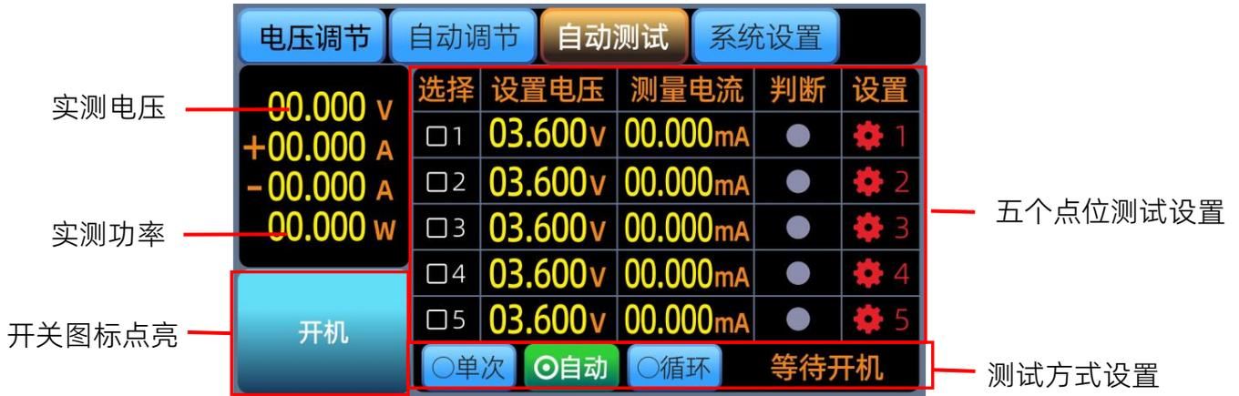
图5.6.1 电池充放电自动测试
