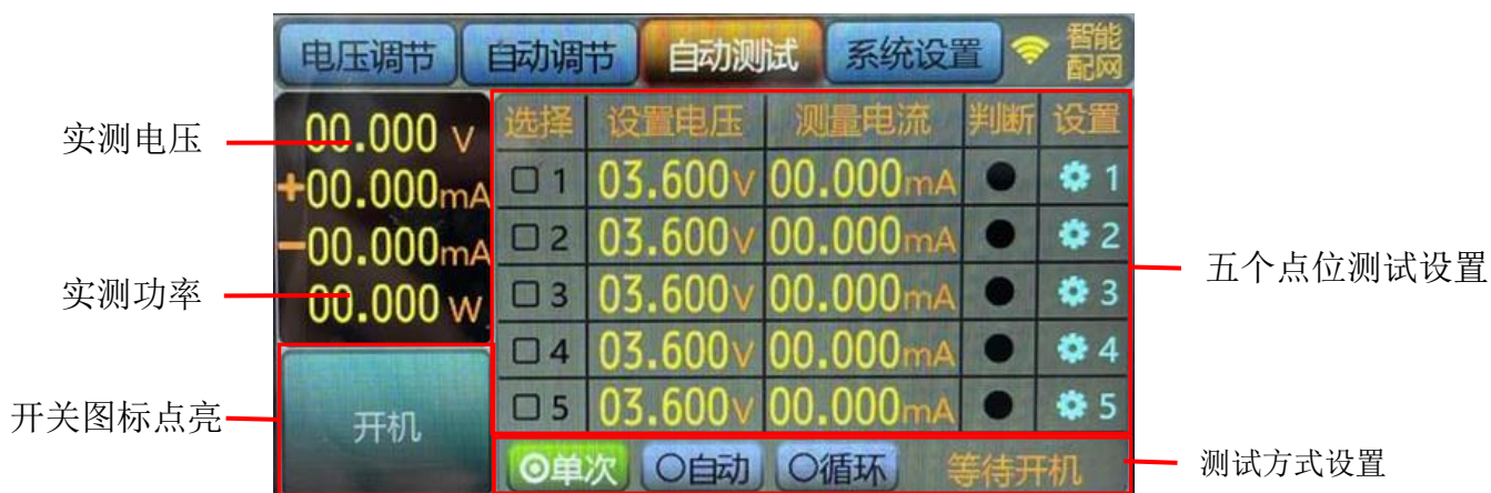
图5.6.2 电池充放电自动测试
