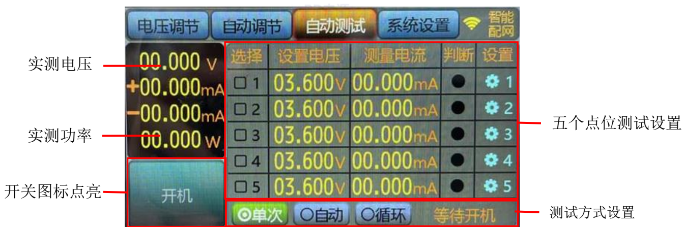
图5.6.1 电池充放电自动测试
