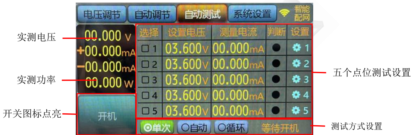
图5.6.1 电池充放电自动测试
