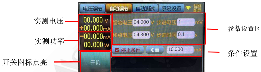
图5.5.1 电池充电饱和和测试
