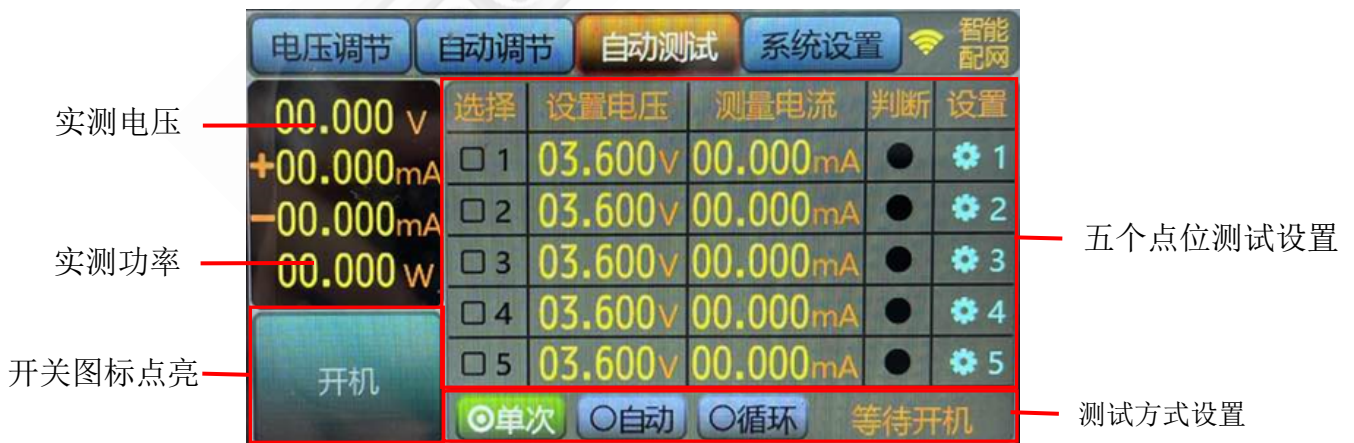
图5.6.2 电池充放电自动测试
