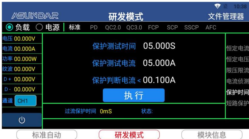
**短路保护：**选择“短路保护”，可测试产品从短路到进入保护状态所需时长。
