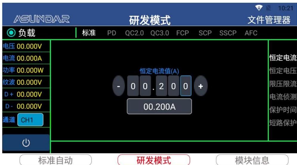
**PD负载：**选择“PD”，可识别并触发产品的PD2.0及PD3.0协议。
