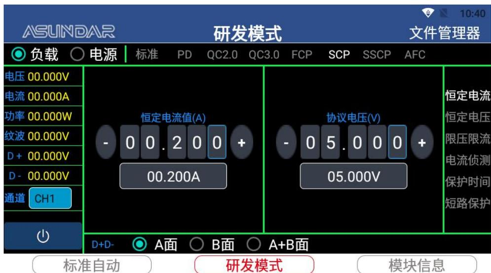
SSCP负载：选择“SSCP”，可识别并触发产品的SSCP协议。
