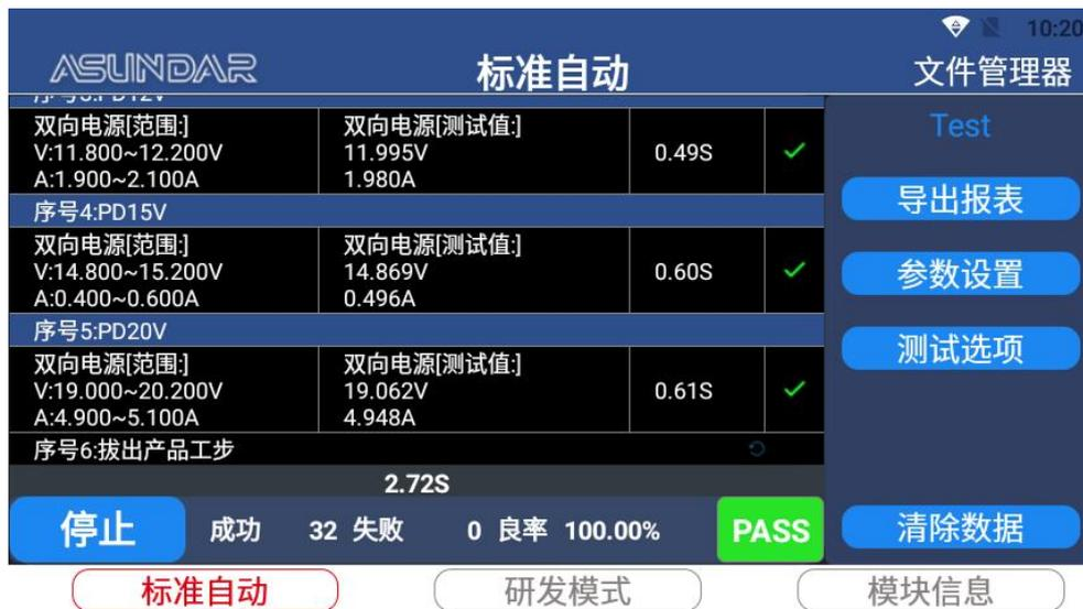
最终测试结果可在标准自动主界面点击“导出报表”按钮，选择将相应测试数据以报表形式导出到存储设备，以便在PC端查看。
