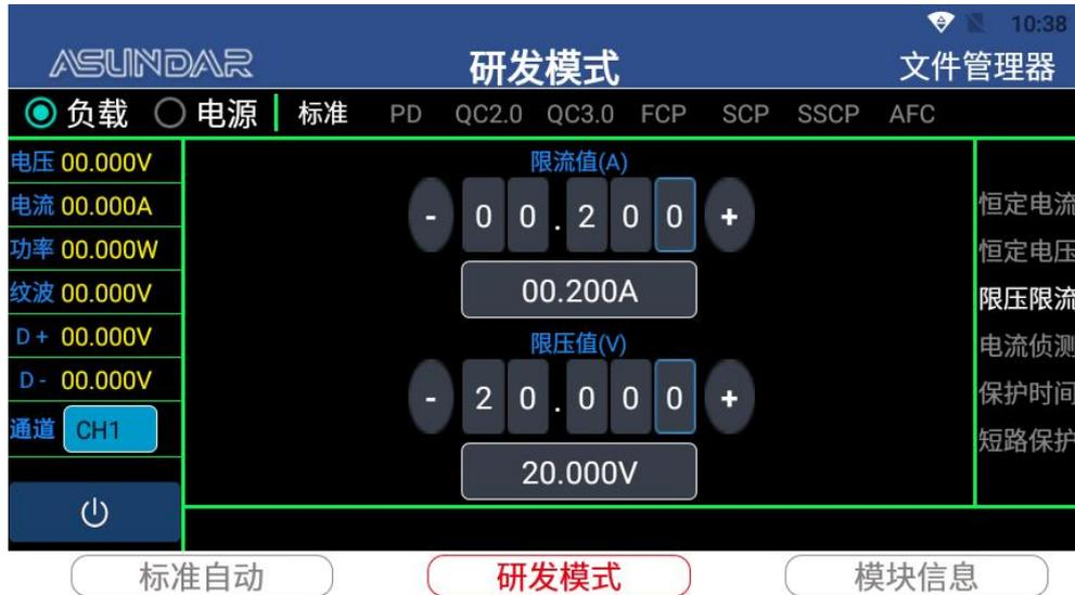
**电流侦测**：选择“电流侦测”，可测试产品的过流保护电流值。
