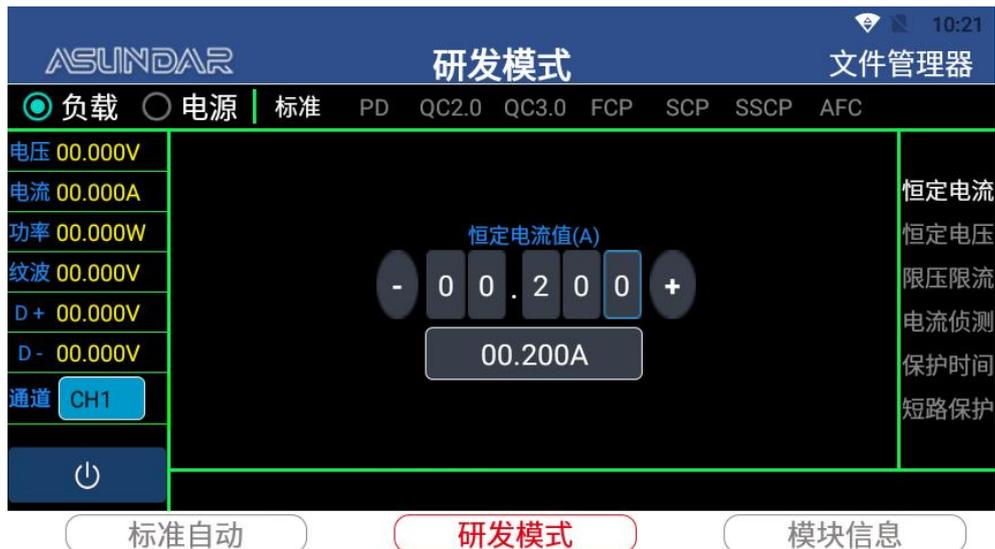
**恒定电压：**选择“恒定电压”，即负载的“恒压（CV）”方式，可设定负载电压。根据产品输出电压和负载所设定恒压电压的差值及传输内阻决定负载电流及功率。
