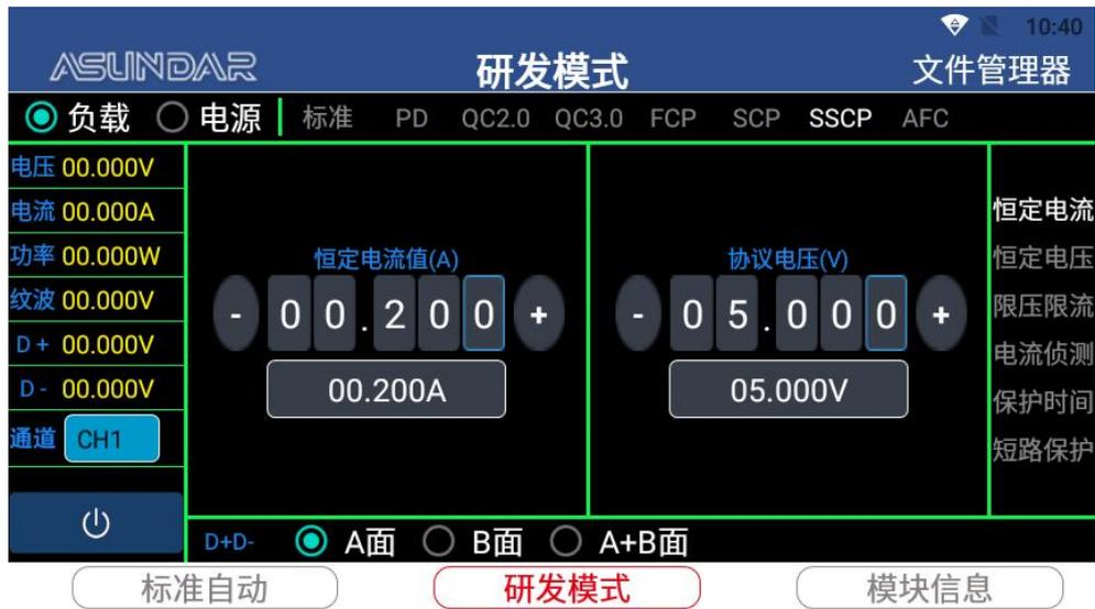
AFC负载：选择“AFC”，可识别并触发产品的AFC协议。
