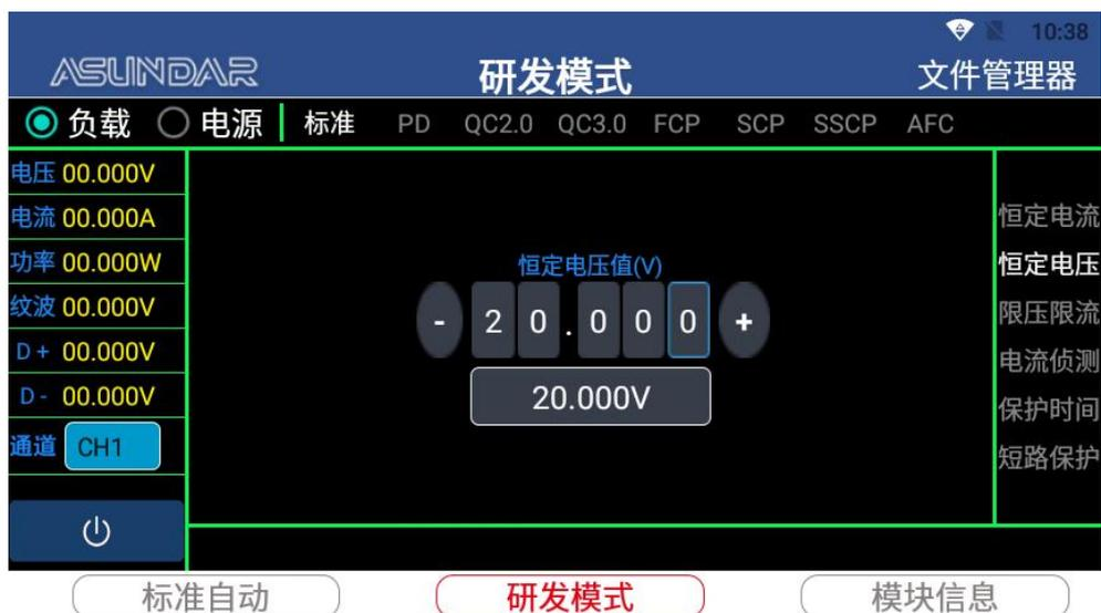
**限压限流**：选择“限压限流”，其负载电流不超过限流值，负载电压不低于限压值。当限流参数较小，限压参数较大时，类似于恒流负载。当限流参数较大，限压参数较小时，类似于恒压负载。
