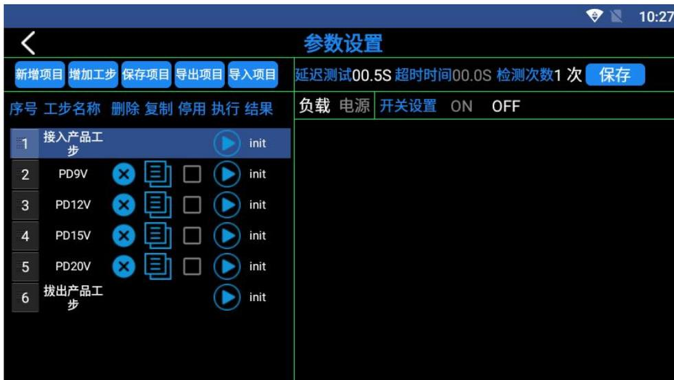
每项工步均可做删除、复制、停用操作，长按名称可进行编辑，长按序号可上下拖动调整顺序，点击执行图标可执行单项测试。
