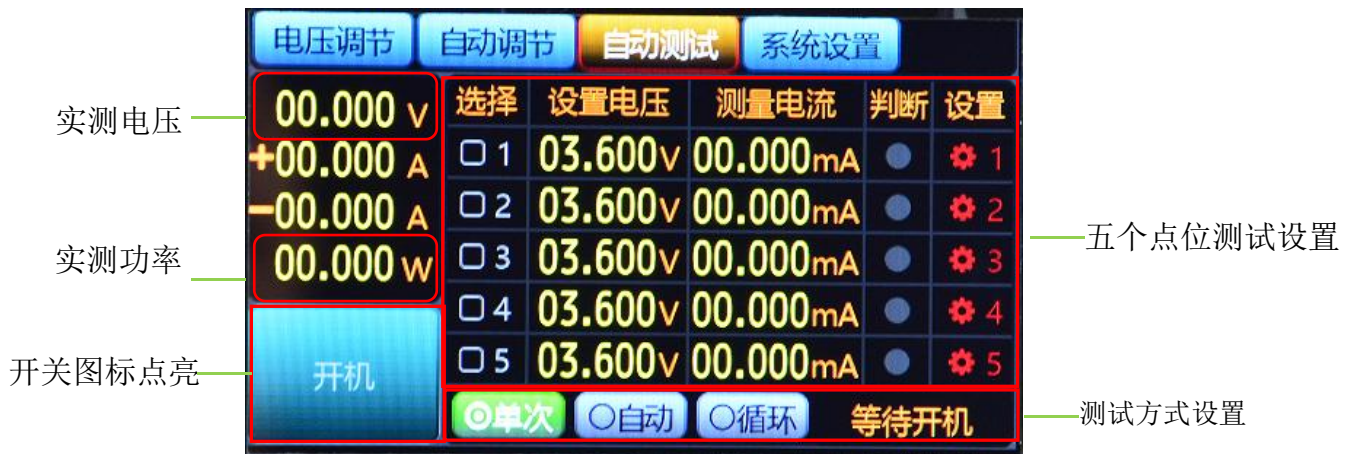
图5.6.1 电池充放电自动测试
