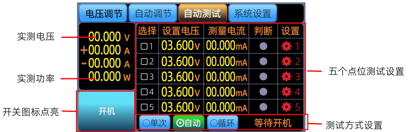
图5.6.1 电池充放电自动测试
